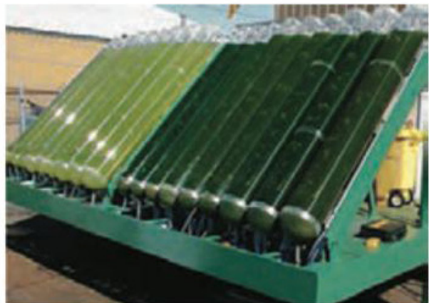
شکل ۱۷- دو نوع فتوبیوراکتور که در آن جلبک تک یاخته‌ای کشت شده است.
